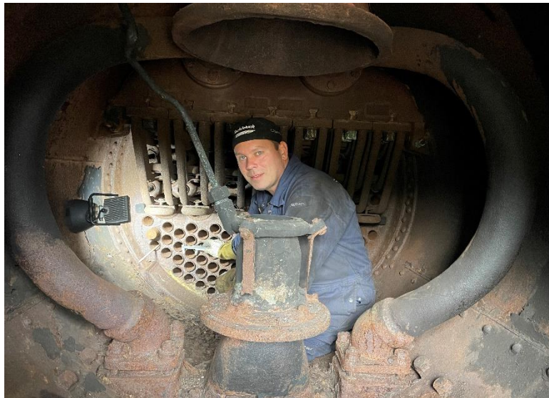
VEÅ:s Jonas Forsén statusbesiktigade LJM ånglok E2 1184 i augusti 2025, här fotograferad i rökskåpet. Loket är generellt i gott skick.
